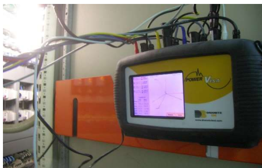
1 - Power Visa Analizzatore di rete
